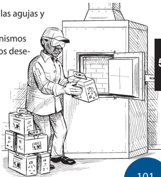
***Incineración a bajas temperaturas:*** Los dispositivos de combustión cuya temperatura no exceda los 400 °C comprenden los incineradores de ladrillo de una sola cámara, los hornos a tambor y las fosas de incineración. La incineración es incompleta. Puede no destruir por completo los microorganismos. Teniendo en cuenta estas deficiencias, la incineración a baja temperatura sólo debe usarse como una solución de corto plazo.
