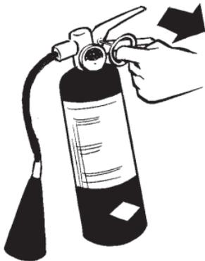
**T**ire de la clavija ubicada en la parte superior del extinguidor.
