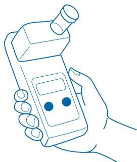
La medición de la turbiedad en el campo se efectúa con un instrumento portátil que permite una medición fácil y rápida. Se recomienda las escalas de 0 a 5 UNT para agua de consumo humano. Su funcionamiento tiene los mismos principios que el método nefelométrico usado en el laboratorio.
